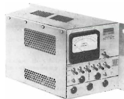
La fotografia mostra il complesso mod. ETT-400 della FAIRCHILD ELECTRO-METRICS CORP., studiato per ricavare dati dai trasduttori usati nei processi industriali e realizzare una serie di allarmi. Funziona con l'applicazione di segnali di microvolt di livello di trasduttori pressione, forza, flusso e altri, comprese termocoppie e termometri a resistenza. L'unità qui rappresentata è adatta e calibrata in particolare per l'uso di elaborazione di dati di termocoppie.
